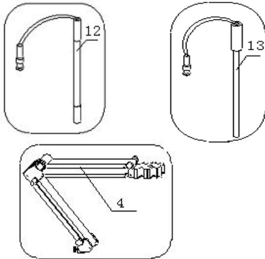
12 — DJS-1C 电导电极      13 — T-818-B-6 温度电极
