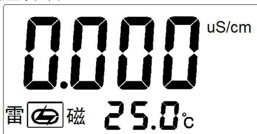
按“温度△”或“温度▽”键调节显示值，使温度显示为被测溶液的温度，按“确认”键，即完成当前温度的设置；按“电导率/TDS”键放弃设置，返回测量状态。
