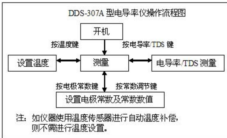
如果仪器接上温度电极时，将温度电极放入溶液中，此仪器显示的温度数值为自动测量溶液的温度值，仪器自动进行温度补偿，用户不必进行温度设置操作。
