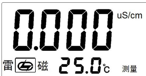
在测量状态下，按“电导率/TDS”键可以切换显示电导率以及 TDS；按“温度”键设置当前的温度值；按“电极常数”和“常数调节”键进行电极常数的设置，简要的操作流程见下图：
