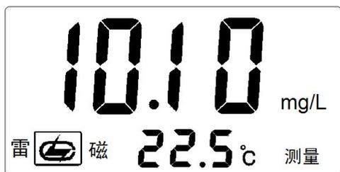
如果仪器没有接上温度电极，则用温度计测出被测溶液的温度，按“4.3 温度设置”操作步骤进行温度设置；然后，仪器接上电导电极，用蒸馏水清洗电极头部，再用被测溶液清洗一次，将电导电极浸入被测溶液中，用玻璃棒搅拌溶液使溶液均匀，在显示屏上读取溶液的 TDS 值。如溶液温度为 25.5℃，TDS 值为 10.10mg/L，则仪器显示如图：
